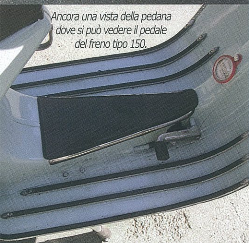
pedana con il tappetino in gomma centrale.
