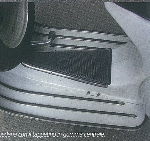
Ancora una vista della pedana dove si può vedere il pedale del freno tipo 150.
